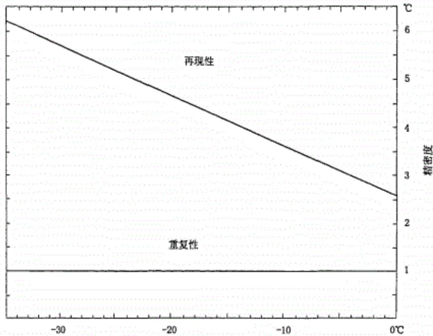
图9 冷滤点的精密度
