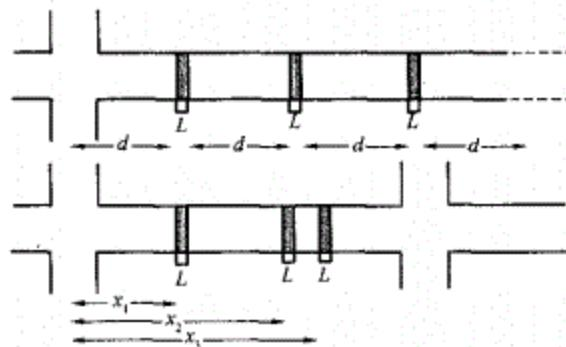
图1 道路积尘采样点布置图
