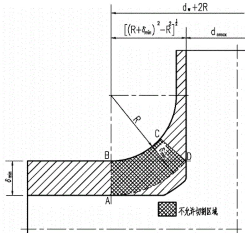
图 27  $D_w \leq 660\text{mm}$  三通过渡区强度尺寸要求
