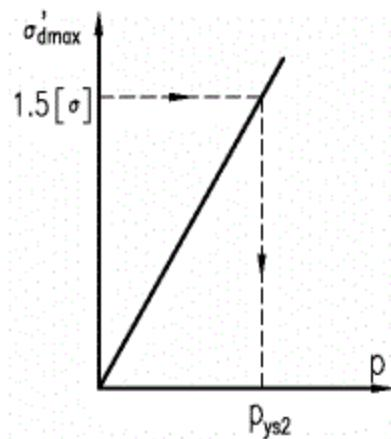
图 34 低应力区域中当量应力最大点的  $\sigma'_{pd\max}$  —  $p$  直线
