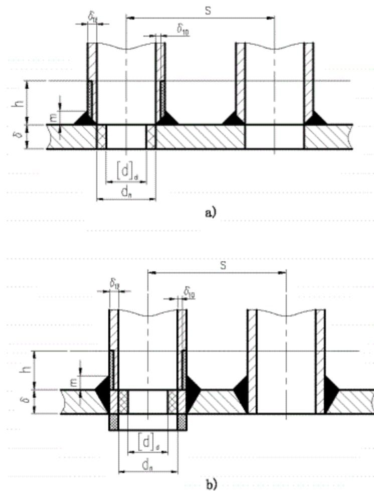
图 21 用管接头补强的孔桥
