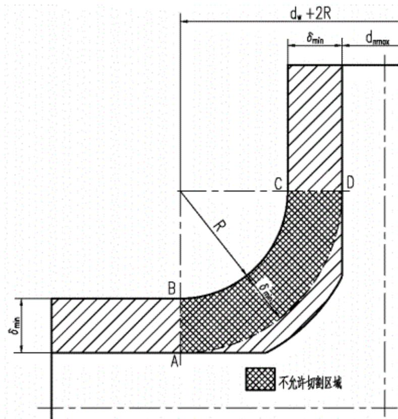
图 28  $D_w > 660\text{mm}$  三通过渡区强度尺寸要求
