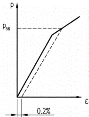
图 37 根据应变最大点的  $p - \varepsilon$  曲线确定  $p_{ss}$  的方法
