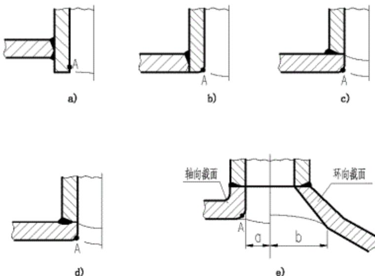
图 A.1 接管与锅筒筒体的整体焊接型式
