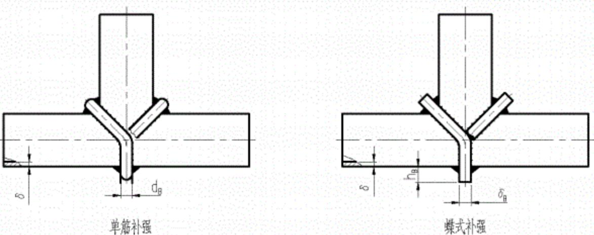
图 22 焊制三通的单筋、蝶式补强型式
