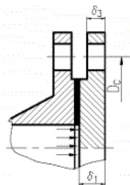
图 15 凸面法兰式盖板
