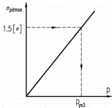
图 35 高应力区域中内外壁平均应力的当量应力最大点的  $\sigma'_{pd\max}$  —  $p$  直线
