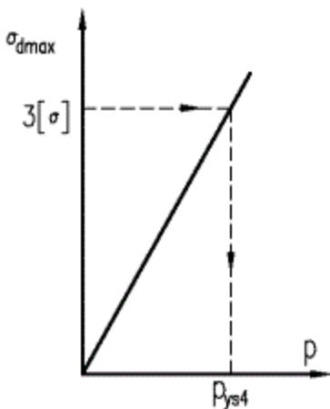
图 36 高应力区域中当量应力最大点的  $\sigma_{d\max}$  -  $p$  直线
