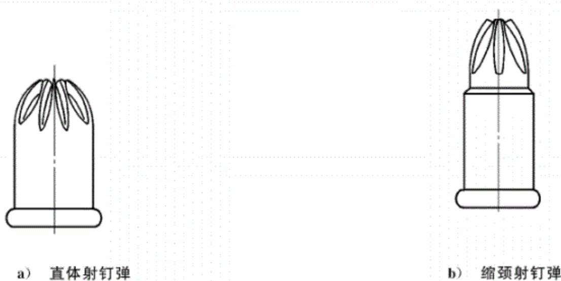
**图 2 直体和缩颈射钉弹示意图**
