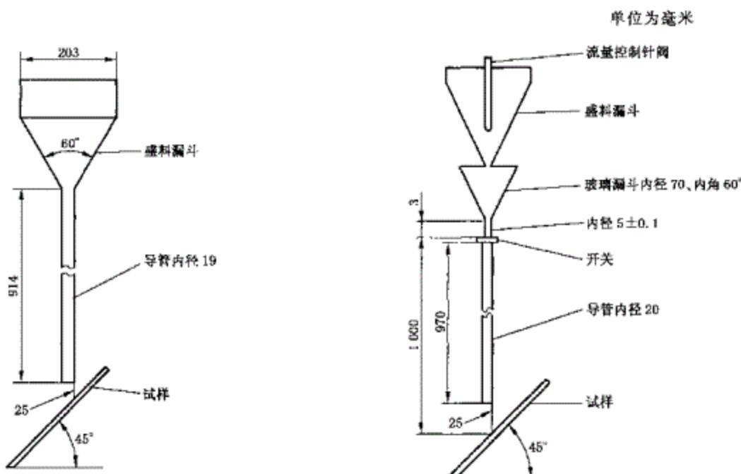
图 B.1 氟碳涂层和陶瓷涂层落砂试验
