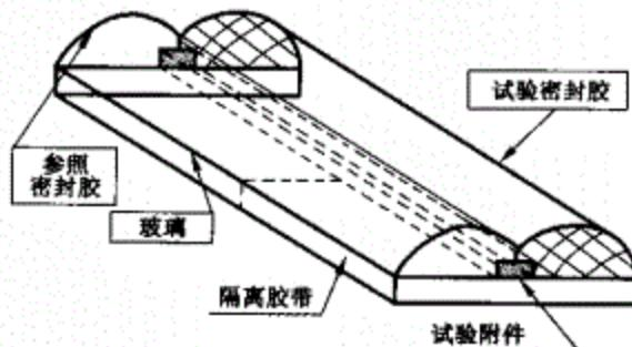
图A.3 附件相容性试验的试件形式
