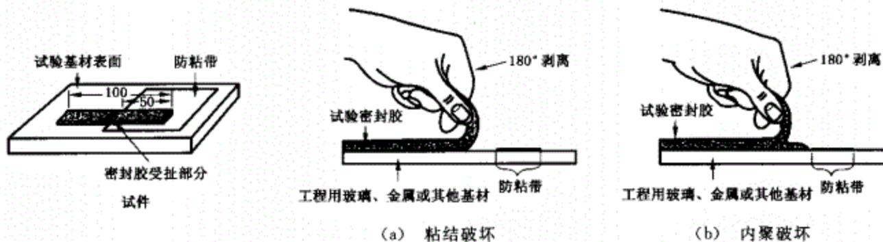
图 D.2 非破坏手拉剥离试验
