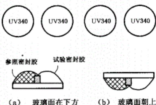
图A.1 光照试件的放置
