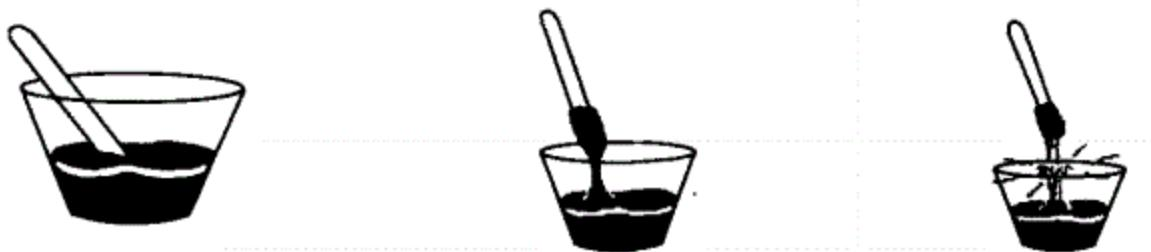
图 D.4 拉断时间试验
