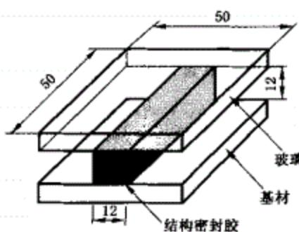
图 2 拉伸粘结试件
